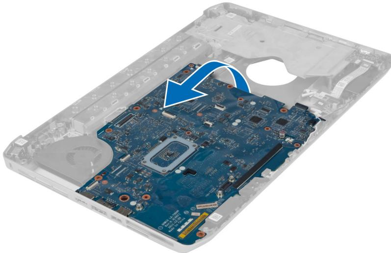
7. Remova a placa de sistema após liberá-la dos conectores de porta no lado esquerdo.
