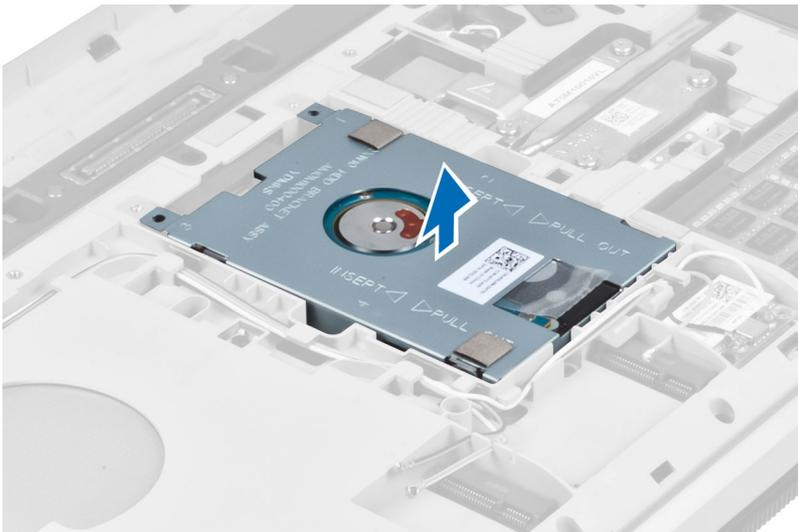
6. Remova os parafusos que prendem o suporte do disco rígido.
