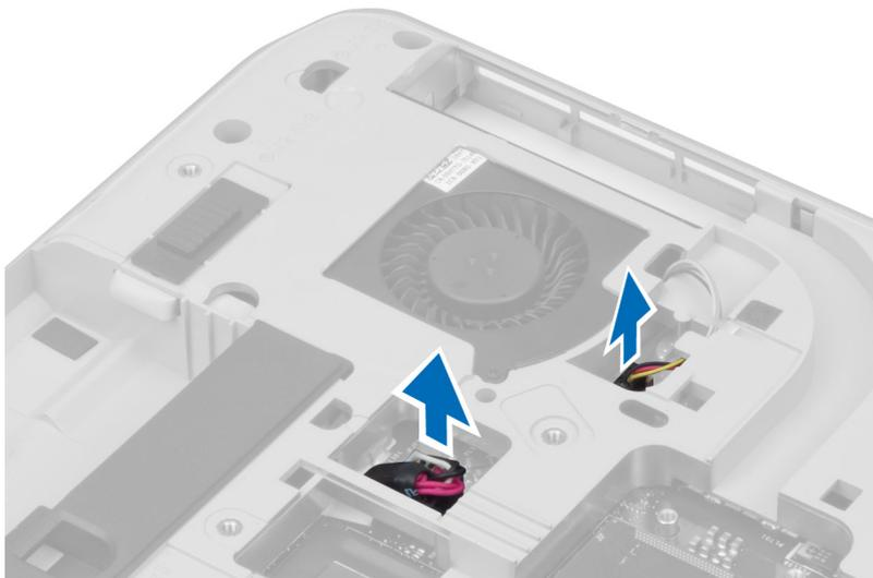
4. Desconecte o cabo do alto-falante e o cabo flexível de áudio da placa de sistema.
