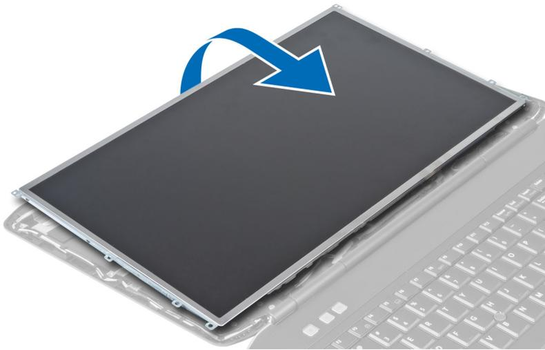
5. Remova os adesivos e desconecte o cabo de LVDS da parte traseira do painel da tela.
