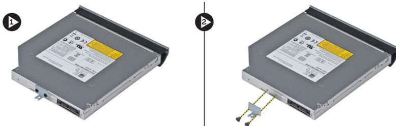
8. Desencaixe as abas da tampa da unidade ótica para separar a tampa da unidade ótica.
