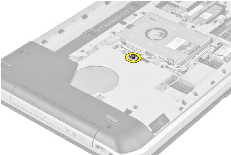
4. Empurre a aba do parafuso afastando-a do computador para liberar a unidade ótica do compartimento da unidade.
